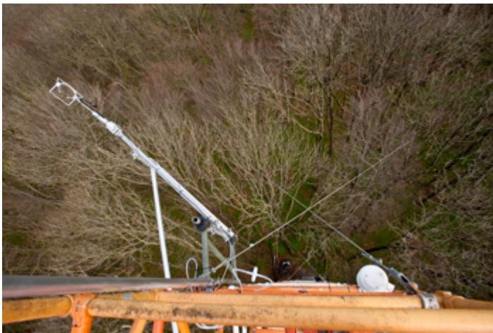
Abb. 2: Mit Hilfe von Ultraschallwellen erfassen Anemometer Luftwirbel über Blätterdächern und Graslandschaften. Die Hochfrequenzwellen breiten sich je nach Windverhältnissen unterschiedlich schnell zwischen zwei Detektoren aus.
