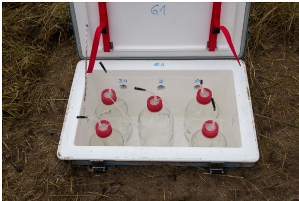
Bodenwassersammelkiste mit Sammelflaschen, die mit feinporigen Glasinterplatten in fünf verschiedenen Bodentiefen verbunden sind, © Vanessa-Nina Roth, MPI-BGC
