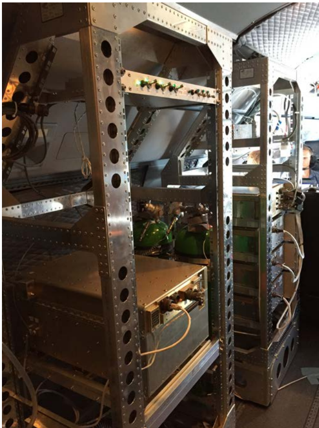
Instrumente vom MPI für Biogeochemie im Forschungsflieger HALO: links das Jena Instrument for GHGs (JIG), ein Cavity Ring-down Spectrometer für \text{CH}_4 , \text{CO}_2 , \text{CO} , \text{H}_2\text{O} , und rechts der Jena Air Sampler (JAS) zur Probenahme mit anschließender Analyse auf Isotopen von \text{CH}_4 und \text{CO}_2 . (Foto: Christoph Gerbig, MPI-BGC)
