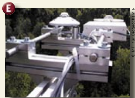
▲ Strahlungsmessgeräte an einem mikrometeorologischen Messturm.
