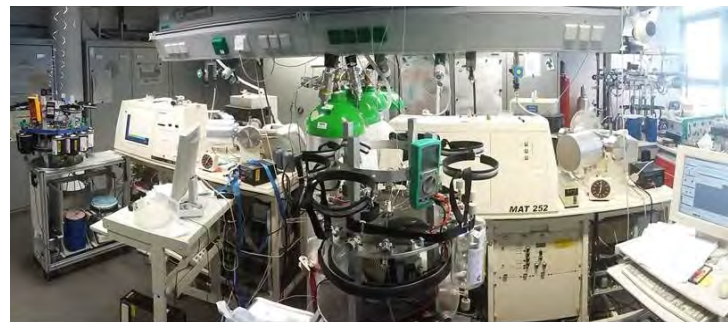
Zwei MAT 252 (Thermo Finnigan) Isotopenverhältnis-Massenspektrometer (IRMS), die an haus eigene Probenaufgabesysteme (BGC-Air Trap) gekoppelt sind. Die BGC-Luftfalle trennt das \text{CO}_2 von den anderen Luftbestandteilen, konzentriert es auf und leitet es in die Massenspektrometer ein. Diese IRMS Geräte messen die ^{13}\text{C}/^{12}\text{C} und ^{18}\text{O}/^{16}\text{O} Verhältnisse von \text{CO}_2 in Luft. (Foto: H. Moossen)
