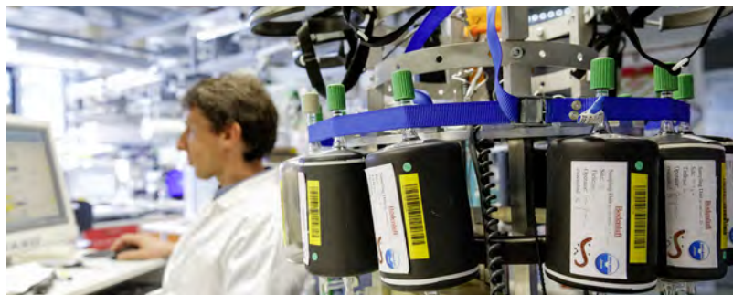
Flask Probenaufgabesystem (BGC-Luftfalle). Hier werden Proben von Messstationen aus aller Welt gemessen. (Foto: A. Schroll)
