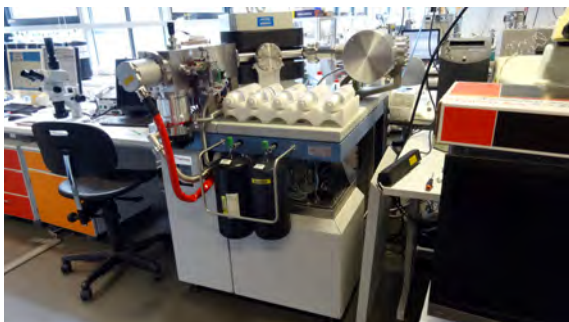
Sektorfeldmassenspektrometer (MAT 253) mit Doppeleinlasssystem für das Messen von reinem CO 2 . (Foto: S. Hejja)
