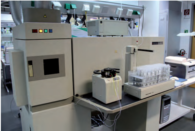
Atom-Emissionspektrometer mit dem ICP-Verfahren (induktiv gekoppeltes Plasma), 'Optima 3300DV' von Perkin Elmer
