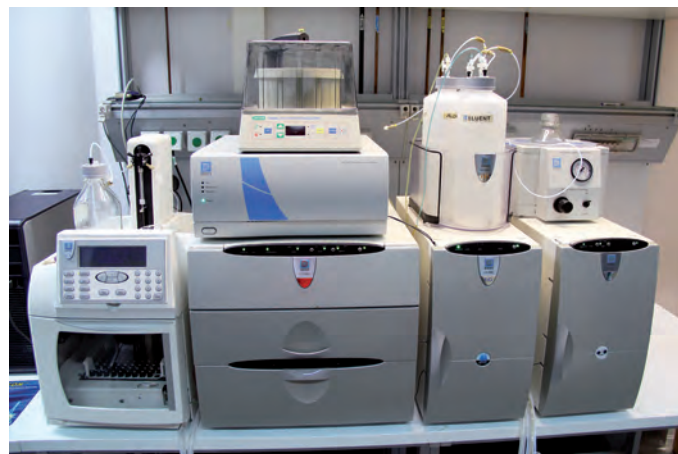
Ionen-Chromatograph mit amperometrischer Detektion, 'ICS-3000' von Dionex
